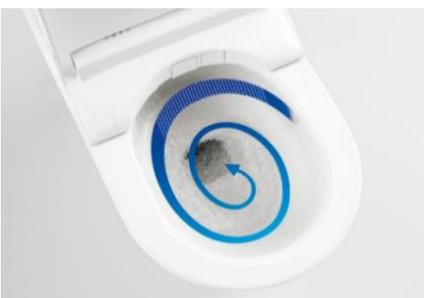
渦を巻くようなトルネード洗浄が、少ない水で効率的に洗浄します。汚物が付着しやすい便器後方に勢いよく水が当たるので、汚れをしっかりと洗い流します。また便器正面から吐水口が見えないので、見た目もすっきりしました。
